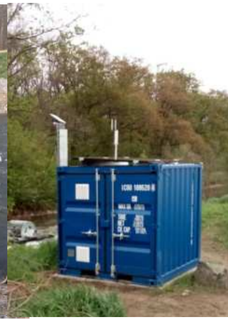
Basisstation mit Solar, Speicher & Fernüber- wachung
