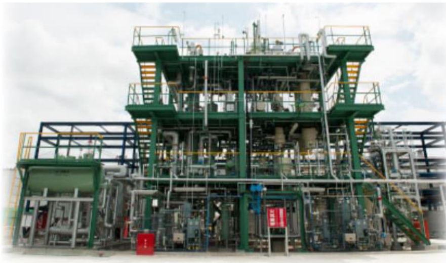
Pilotanlage bei Chiyoda in Japan: Produktion von 50 \text{ Nm}^3 \text{ H}_2 pro Stunde Eingesetzter Träger: Toluol / Methylcyclohexan
