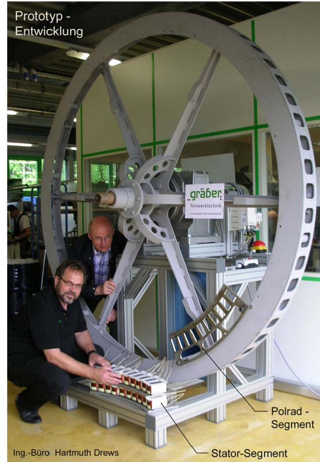
Radreifen: Stahlblech ca. 225 kg
