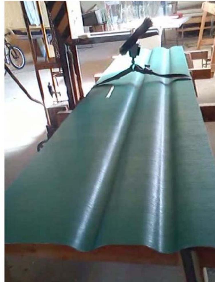
GFK - Schaufelblatt 1,00 m x 5,00 m
