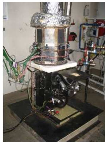
boiler 10 kW th , 200 W el
